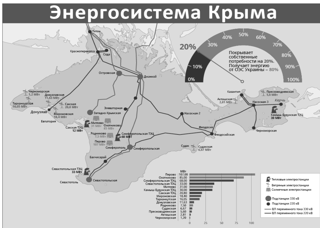
Рис. 1. Расположение объектов электроэнергетической отрасли Крыма Источник: Переток.ру [12].
